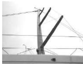
Photo 4: [Mast & Rig] フォア&バック・ステイや、ジャンパー、ランナーなどの有無が確認でき、また、スプレッダーの後退角の状態が判別できる写真。
